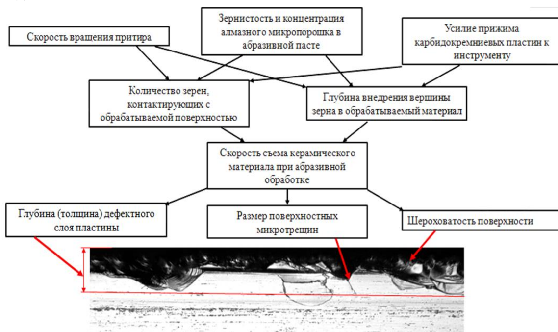
Рисунок 4. Взаимосвязи скорости съема материала с технологическими режимами обработки и параметрами качества поверхности карбидокремниевой пластины
